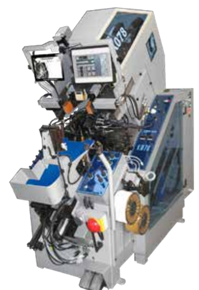
AVANTIUM K078 MÁQUINA DE MONTAR E CENTRAR BICOS
